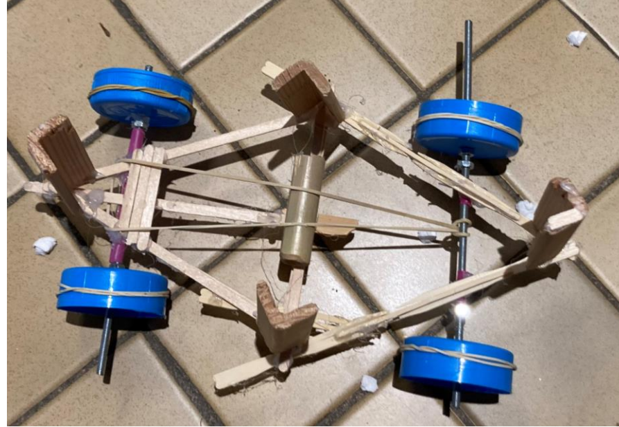
Tige filetée sciée, bouchons de bouteilles de lait, morceaux de pailles, touillettes à café, morceau de bambou scié, barre d'angles sciées... et élastiques sur les roues sinon les roues glissent sans s'accrocher au sol, et donc le véhicule n'avance pas.
