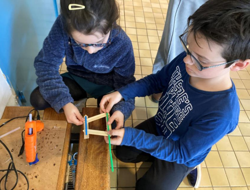
Montage des essieux sur le châssis : on colle des pailles et on y enfle un pic à brochette.
